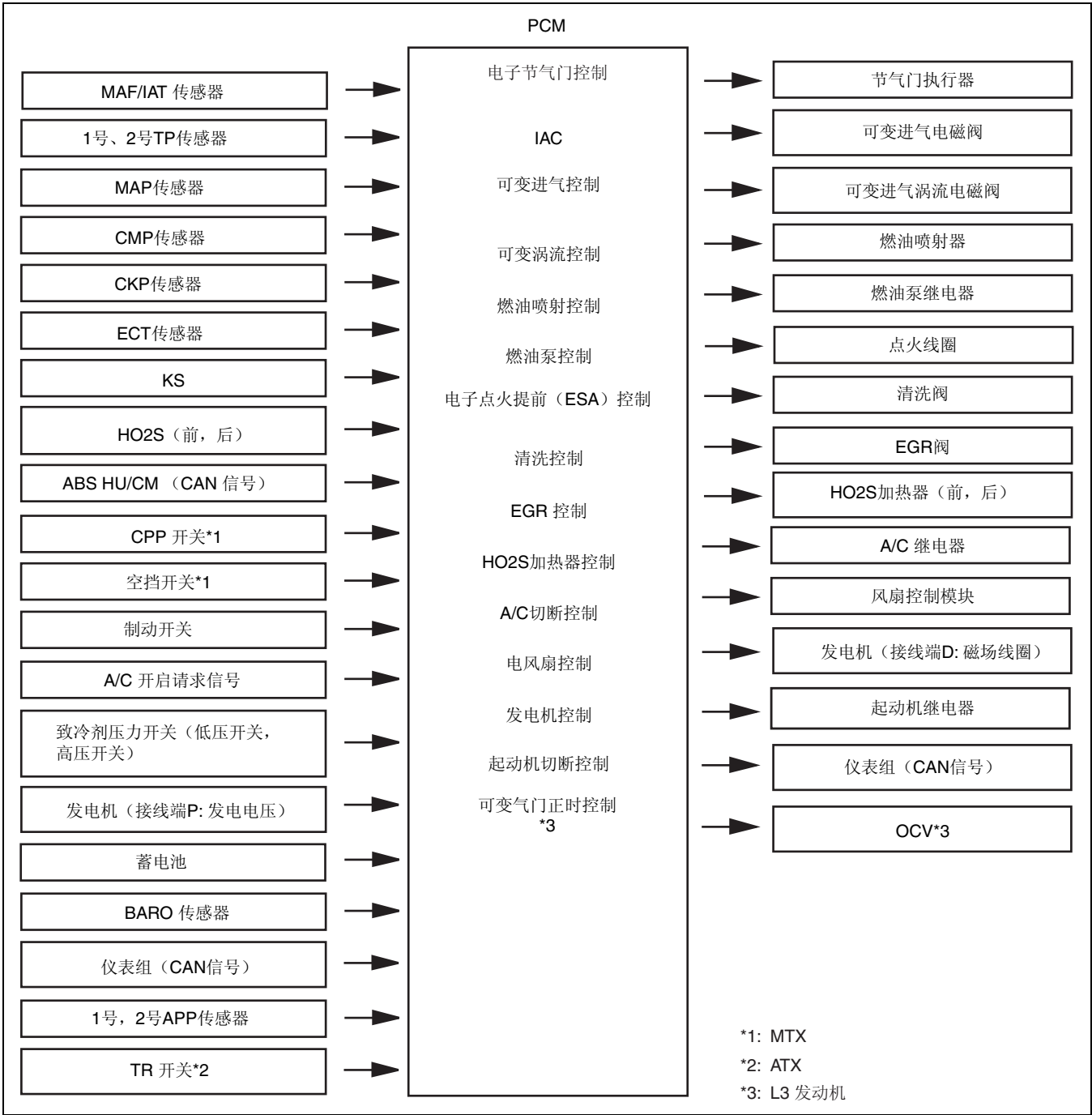
发动机控制系统框图
